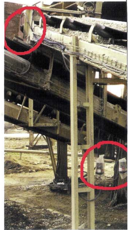
MEMOLUB® lubrifie des composants à 8m de distance.
